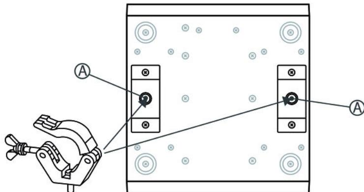
A Filetage pour la poignée de fixation ou des pinces de traverses (clamps)
